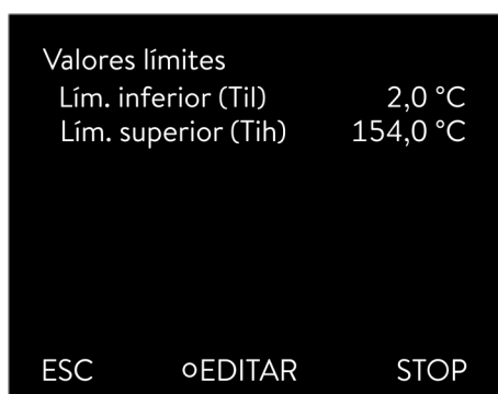
Fig. 38: Fijar los valores límites de temperatura
