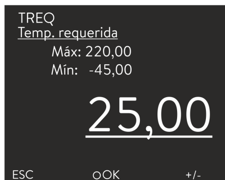
Fig. 39: Ajuste de la temperatura nominal
